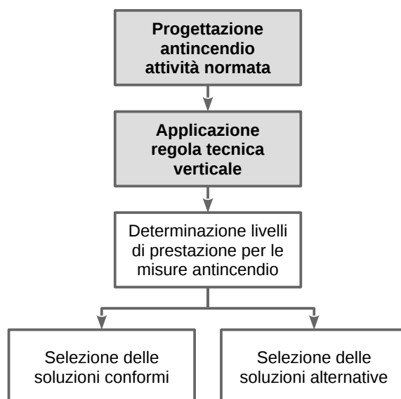
Illustrazione G.2-4: Progettazione antincendio delle attività normate
