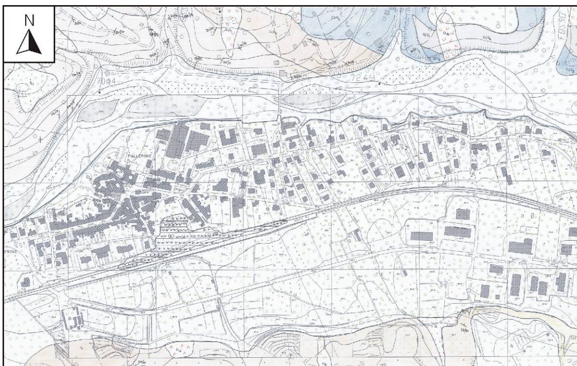
Figura 3.3-6 – Esempio di carta geomorfologica realizzata nell'ambito del Progetto VEL (Regione Toscana) da rilievo in scala 1:2000 (ai fini della rappresentazione nel presente documento la scala è stata ridotta).
