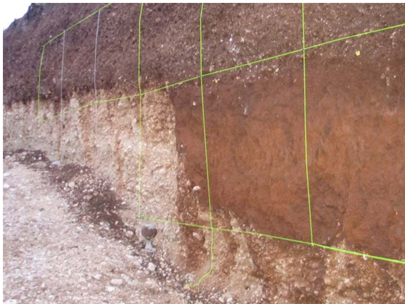
Figura 3.1-5 - Esempio di trincea paleosismologica (T9 della Figura 3.1-4). E' evidente la dislocazione dei depositi olocenici
